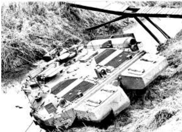
Byte GT på strv 103 under fältmässiga förhållande med hjälp av kranen på Bgbv 82. Bytet gjordes av personal ut TygK. (EP)
