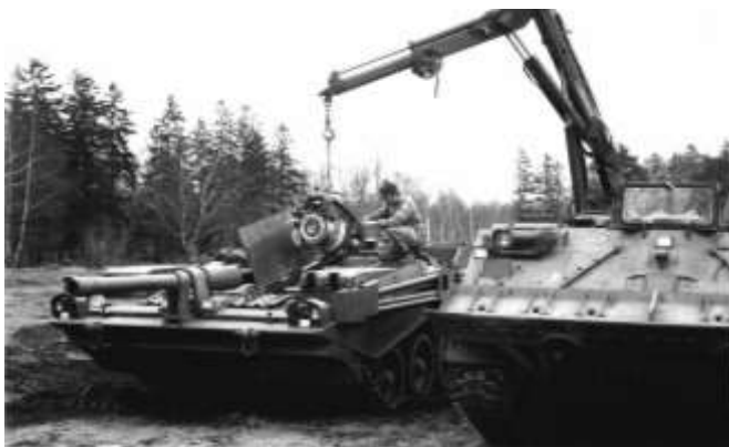
Byte GT på strv 103 under fältmässiga förhållande med hjälp av kranen på Bgbv 82. Bytet gjordes av personal ut TygK. (EP)
